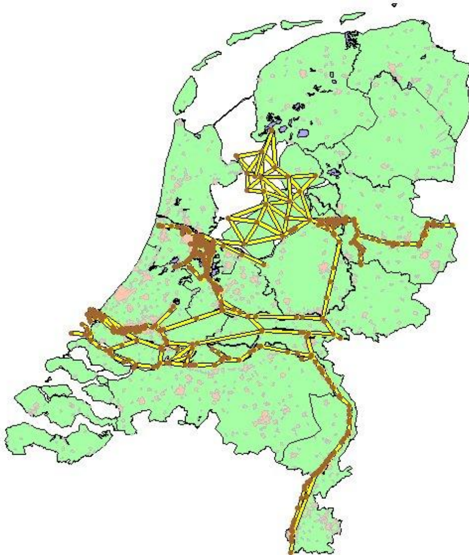
Figuur 3.1b Schematisatie van het Landelijk Temperatuurmodel in GIS met afzonderlijke kaartlagen voor segmentlimieten en DELWAQ segmenten
