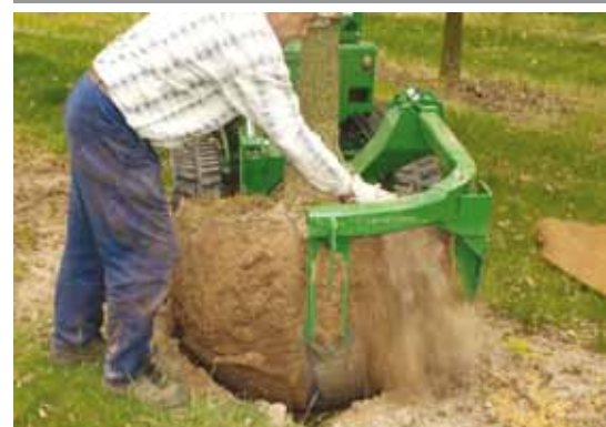
Door het mes terug onder de kluit te brengen, kan de kluit worden gelift.
