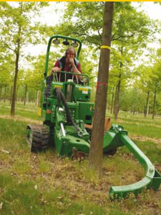
Het mes trilt de grond in. De meeste kracht heeft de machine wanneer het mes er recht voor staat, maar er is een mogelijkheid schuin naar rechts of links te rooien. Een stabilisator aan de achterkant laat de machine horizontaal staan wanneer de messen de grond in gaan.
