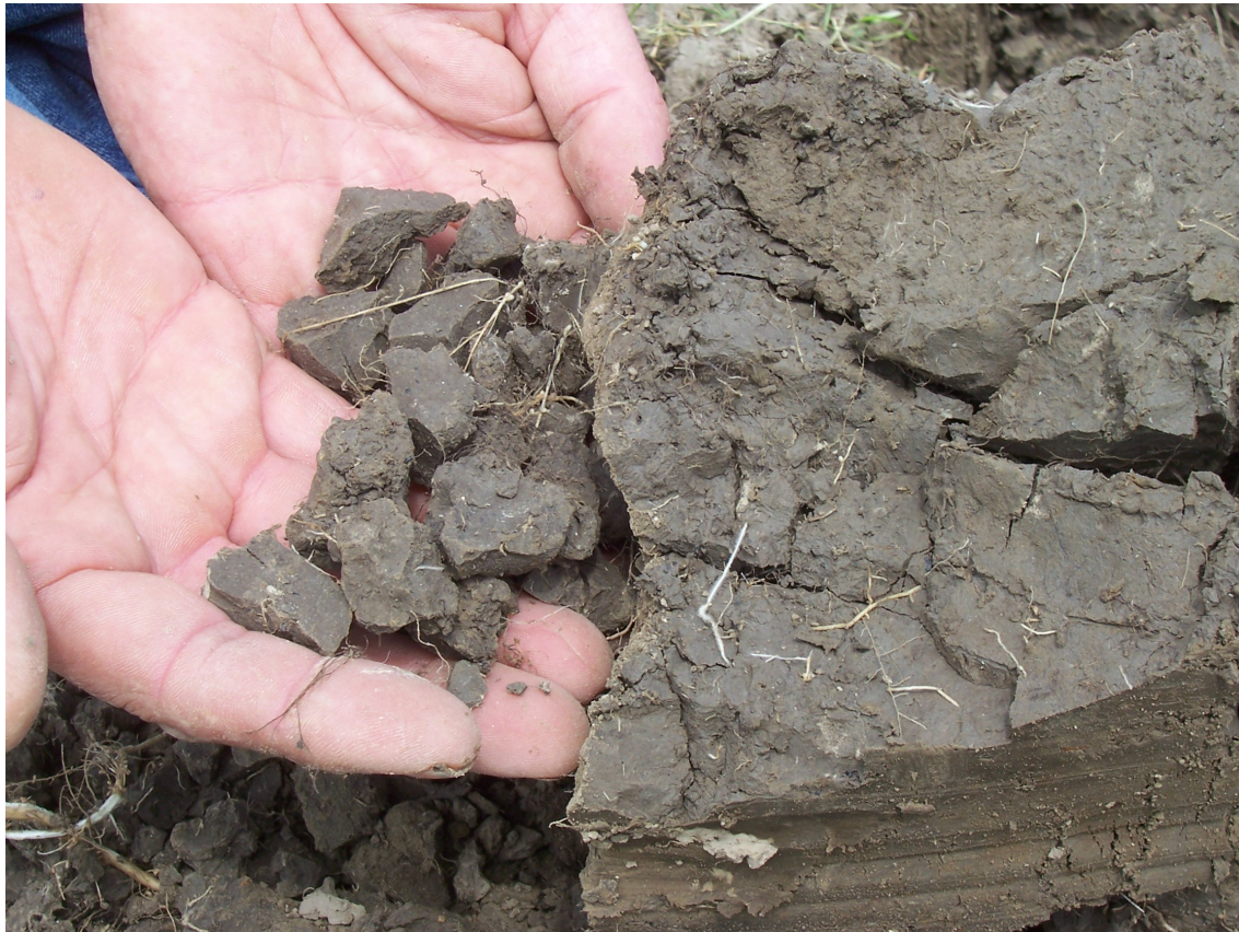
Figuur 3-10 Figuur 6b. Als gevolg van vorst in de winter 2008/2009 is er een prisma-achtige scherpboekkige structuur ontstaan in wat diepere bodemlagen. Dit is erg belangrijk voor de ontsluiting van de ondergrond.
