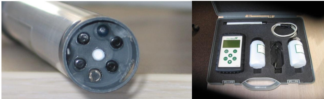
Figuur 1-2. Ion specifieke meters voor NH_4 , Na, Ca, Mg, K en NO_3 . PO_4 , Cl en SO_4 en zelfs H_2O_2 volgen later terwijl ook Fe, Mn, Zn en Cu haalbaar lijken.
