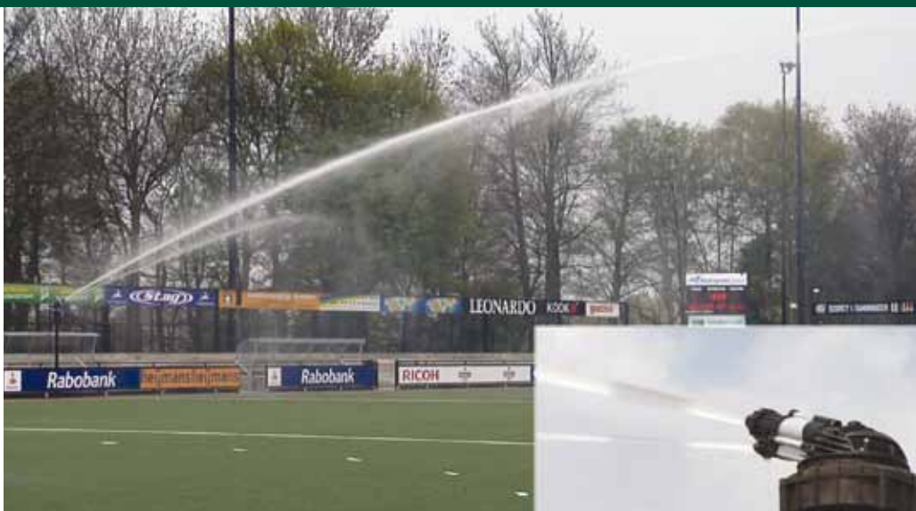
Jan Smits: "Deze installatie zorgt voor 2 mm neerslag per 10 minuten ideaal voor een kunstgras hockeyveld."
