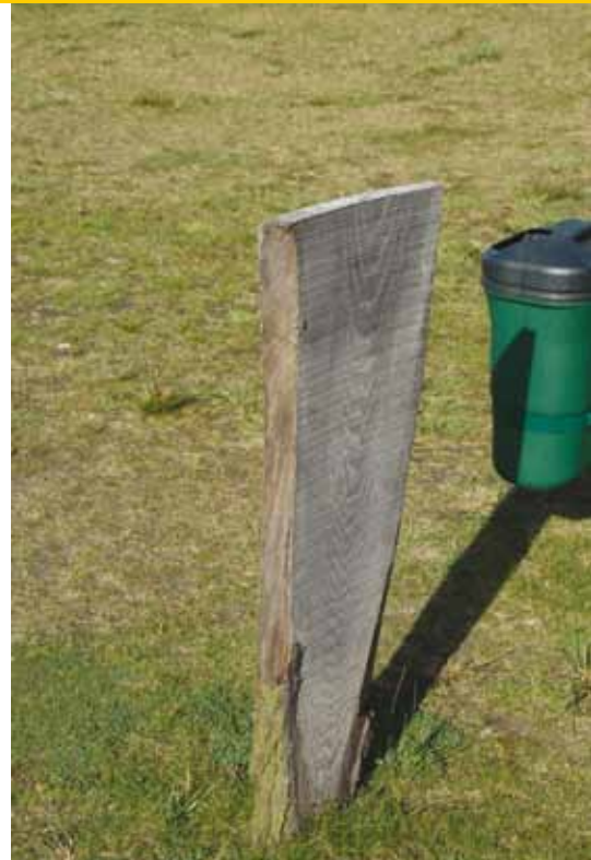
Duurzaamheid op de tee-box: dikke eikenhouten plank, ongeconserveerd, versgezaagd.
