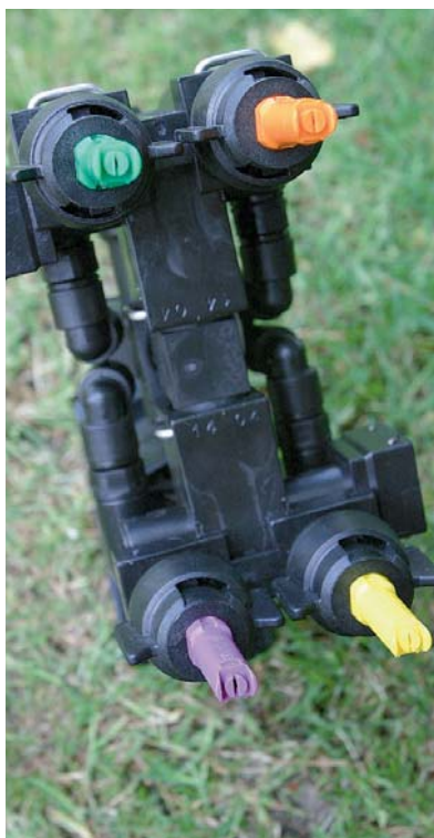
De VarioSelect meervoudige dophouder van Lechler maakt het mogelijk om de vloeistofafgifte tijdens het rijden aan te passen.
