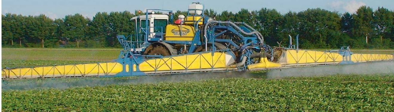
De luchtzak van de Delvano Bi-air is ingebouwd in het frame van de spuitboom.
