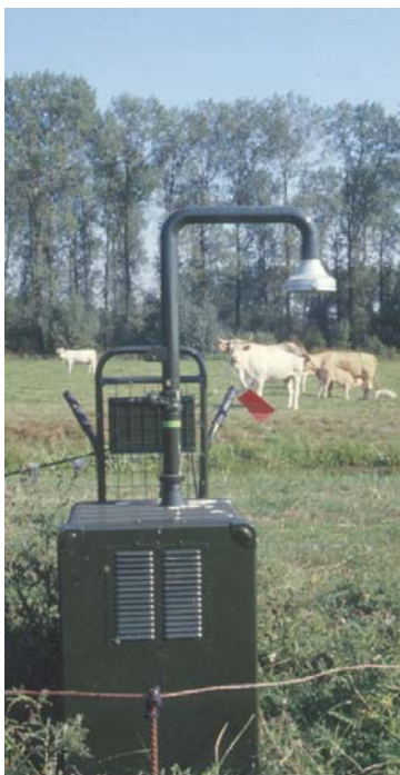
Figuur 2.4. Gromoz sampler zoals gebruikt voor het nemen van de luchtmonsters. In de kast zit de aanzuigpomp. De stang naar boven is het aanzuigstuk en aan het begin daarvan zit het kwartsfilter.
