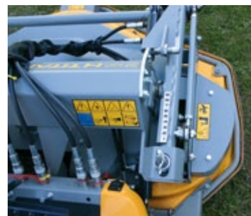
Op het maaidek is een grove schaalverdeling van de maaierhoogte aanwezig.
