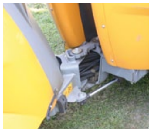
De Stiga Titan 26 is voorzien van knikbesturing.
