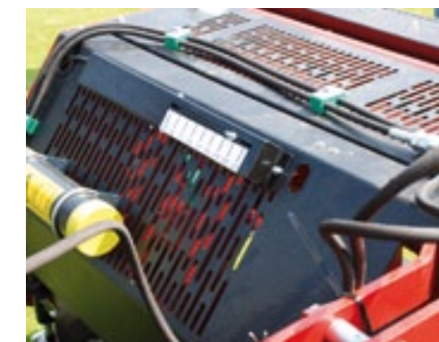
De Verti-Drain Concorde 122.020 is een nieuwe, snelle penbeluchter. Hij prikt gaatjes tot 22,5 cm diep op hoge snelheid. De aandrijving gebeurt via een tandwielkast in het midden. Aan de rechte drijfstanden kunnen pennen van 12,5 tot 24 mm. Eenvoudige schokdempers brengen de pennen na prikken in de juiste positie terug. De centrale hoekverstelling is met bouten vast te zetten. Standaard is hydraulische diepteverstelling met een aanwijzer die je vanaf de trekker kunt zien. Achterop zit een zware rol. De Concorde weegt 1.050 kg, werkt 208 cm breed en kost 27.050 euro exclusief btw.
