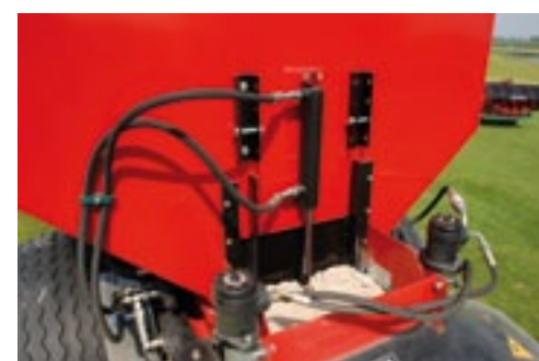
De Rink strooiers zijn verbeterd en uitgebreid met de getrokken DS2000 schoteldresser. In deze topdresser kan 2 kuub zand. Hij is hydraulisch te verstellen. De machine heeft hiervoor een eigen hydraulisch systeem, aangedreven door de trekkeraftakas. Hij heeft twee schotels die tegen elkaar in draaien. Die kun je, net als de bandsnelheid, via regelaars verstellen. Dit kan optioneel elektrisch vanaf de trekker. De Rink 2000 kost 14.700 euro.
