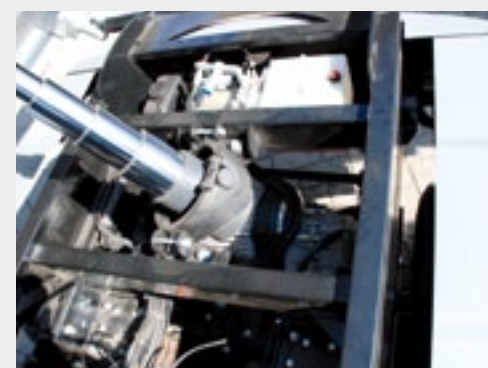
Bij de versie met tweewielaandrijving ligt de elektromotor met transmissie overdwars tussen de twee achterwielen.
