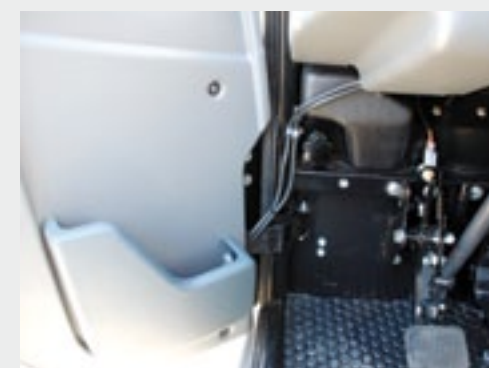
Het scharnier van de deur is beveiligd met een band, zodat de deur niet door de scharnier kan slaan.
