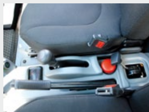
Tussen de stoelen zit de handrem met daarnaast een ronde pook voor de hoge en lage gearing.
