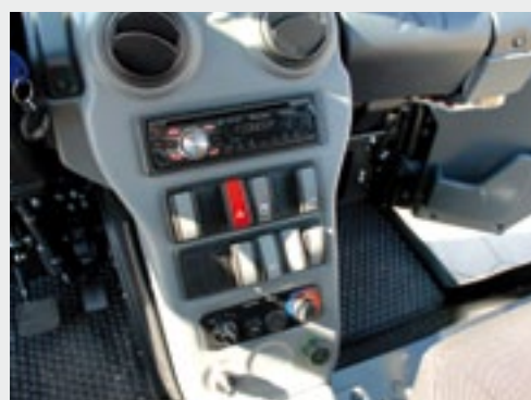
Helemaal links onder op het middenconsole zit een draaiknop voor de vier rijmodussen: eco, sport, towing en climbing.
