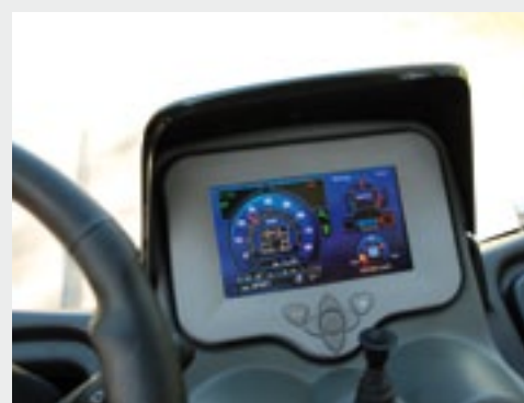
Het display met ampèremeter, 'brandstofmeter' en snelheidsmeter met toerenteller. Het joystickje is voor de rijrichting.
