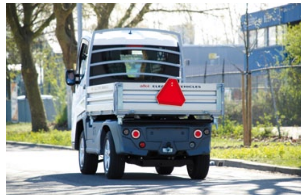
De XT is 143 cm breed en kan ook als langzaamverkeer zonder kenteken de weg op. Je mag dan officieel niet zo hard, maar wel meer trekken, namelijk 3 ton voor de zwd.
