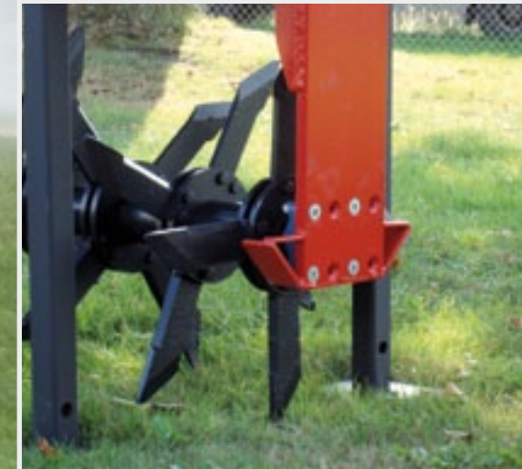
Met een pen-gatverbinding zijn de assen van de 3 meter machine schuiner te stellen, waardoor je de intensiteit van de bewerking instelt.
