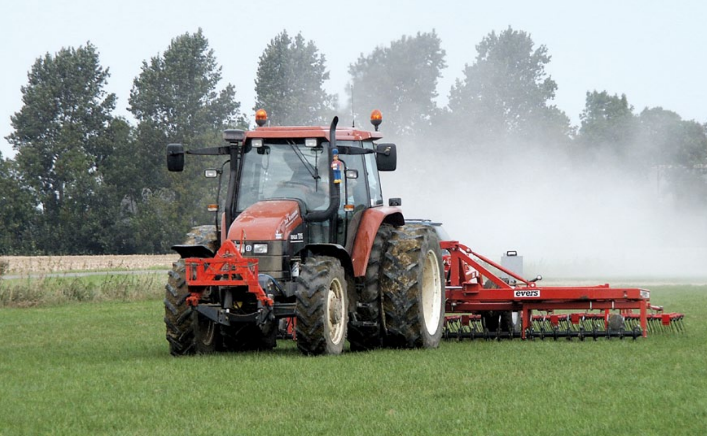
Het effect van een zodebeluchter. Door openingen in de graszode wordt water sneller afgevoerd waardoor minder snel wateroverlast optreedt.
