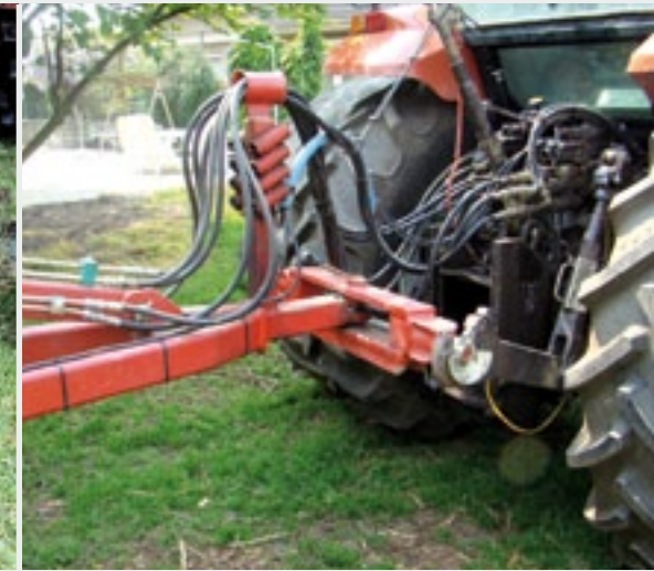
De 3 meter versie hangt in de hef van de trekker. Een 6 meter brede machine ook, maar die wordt optioneel getrokken.
