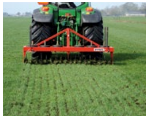
De uitvoering van 3 meter van de Evers graslandbeluchter. Glijsloten voorkomen dat de lagers door de zode gaan.
