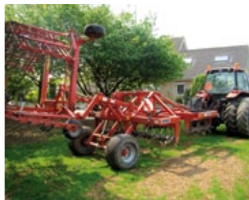
De 6 meter brede beluchter kan voorzien worden van een wielstel en een wiedeg.
