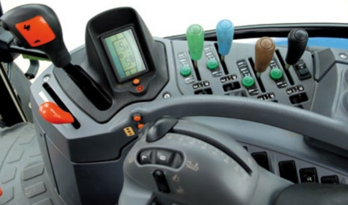
Op de voorgrond de bediening van de hef. Links het handgas en de pook voor groepen en powershift. De dubbelwerkende ventielen van de vier hendels voor de hydrauliek zijn instelbaar op tijd en doorstroming.
