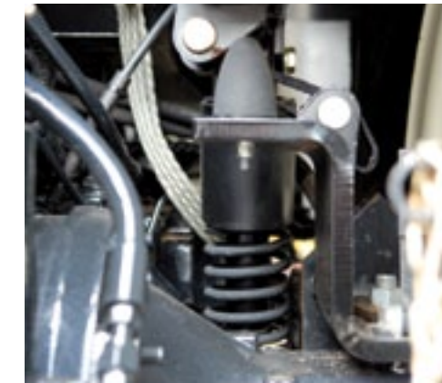
Cabinevering aan de achterzijde is standaard op de Elite en draagt bij aan het comfort.
