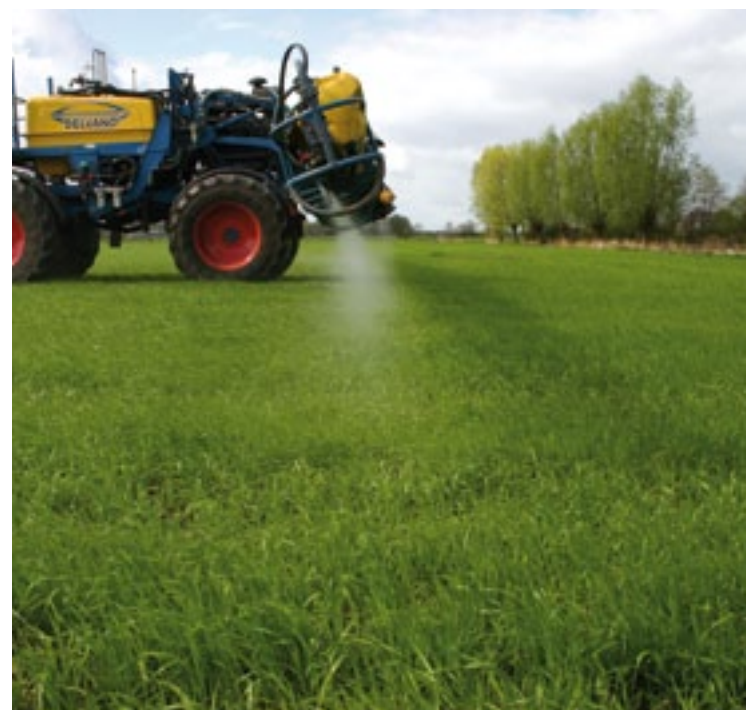
▲ Het verschil tussen niet of wel lucht gebruiken tijdens het spuiten, is hier duidelijk te zien. Met een gekantelde boom is de drift vrijwel nihil ondanks een stevige windkracht 6.
