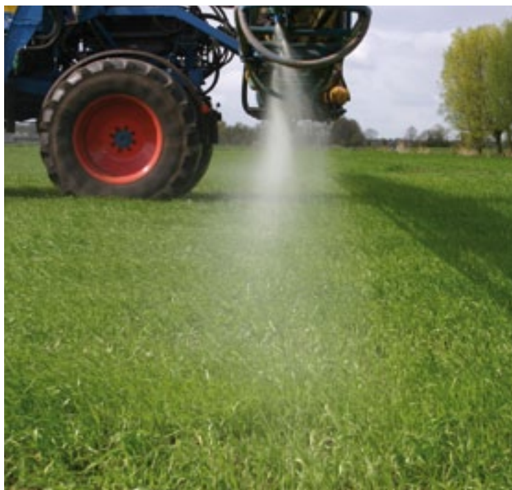
▲ Het verschil tussen niet of wel lucht gebruiken tijdens het spuiten, is hier duidelijk te zien. Met een gekantelde boom is de drift vrijwel nihil ondanks een stevige windkracht 6.
