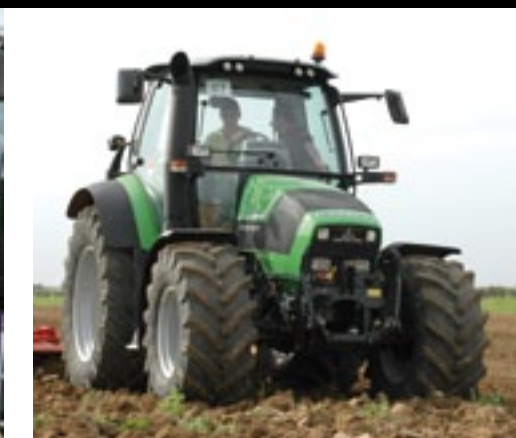
▲ Een compacte, wendbare en relatief sterke trekker met een traploze transmissie, veel hefkracht en veel hydraulisch vermogen.
