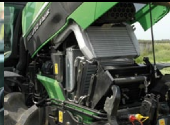
▲ Optimale toegankelijkheid bij het pakket koelers dat vergaand uitklapbaar is. De viercilinder 4-liter Tier-3 common rail diesel is van Deutz.
