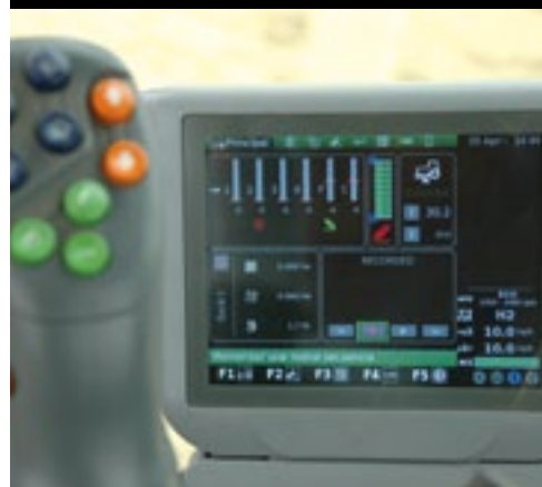
▲ De vertrouwde hendel voor de bediening van onder andere cvt, hydrauliek en hef met het nieuwe beeldscherm van de iMonitor.
