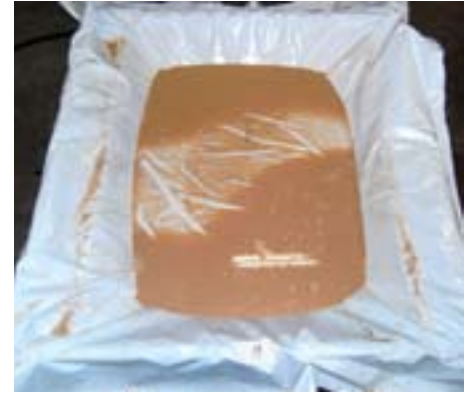
Na 15 minuten afblazen werd deze hoeveelheid ontsmettingsvloeistof opgevangen
