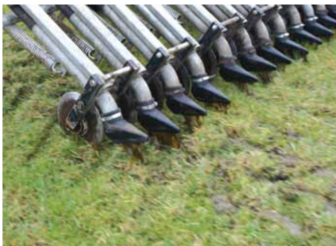
◀ De Agrometer-bemester trok met de kleine schijven te ondiepe geulen en de naar achteren gerichte spuitmondjes sputterden de mest te breed uit voor de eis van vijf centimeter. Er zijn grotere schijven leverbaar.
