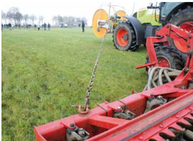
◀ Geertsema vangt de krachten van het keren met de slang op het eind op met een ketting. Zijn Claas stond op 800-banden. Op 1,0 bar deden ze het hier goed.
