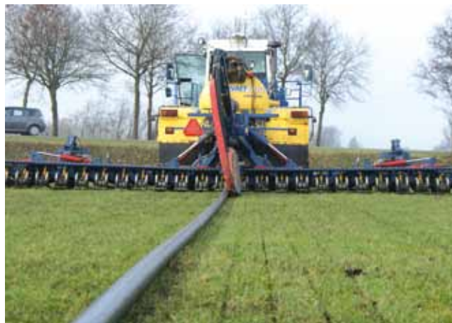
◀ De Hydro Trike van Poland leverde keurig werk af. Er waren twijfels of de gift in het midden voldoende was. Het capaciteitsverschil kon de machine in twee omgangen niet laten zien.
