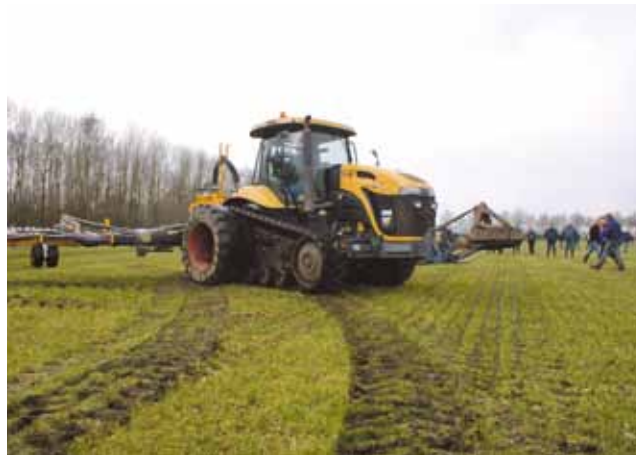
◀ De Challenger beperkte slim de beschadiging van de zode door twee keer te steken. Op het rechte eind was het voordeel van de rups te zien. Twee smalle sporen zonder noemenswaardige insporing.
