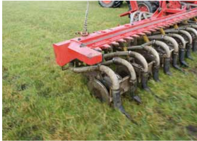
◀ De Roelama haalde hier in dikkere mest een voldoende. De grotere schijven trokken toch wat grotere geulen en de mondjes legden de mest er egaler en smaller in.
