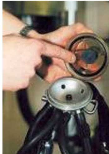
Controle van de melkklauw door voelen. Deze moet stroef aanvoelen.
