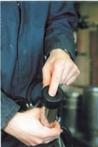
Controle van stootrand van de tepelvoering door voelen met vingertoppen. Rand kan iets vettig zijn en is meestal iets minder stroef dan de schacht van de tepelvoering.
