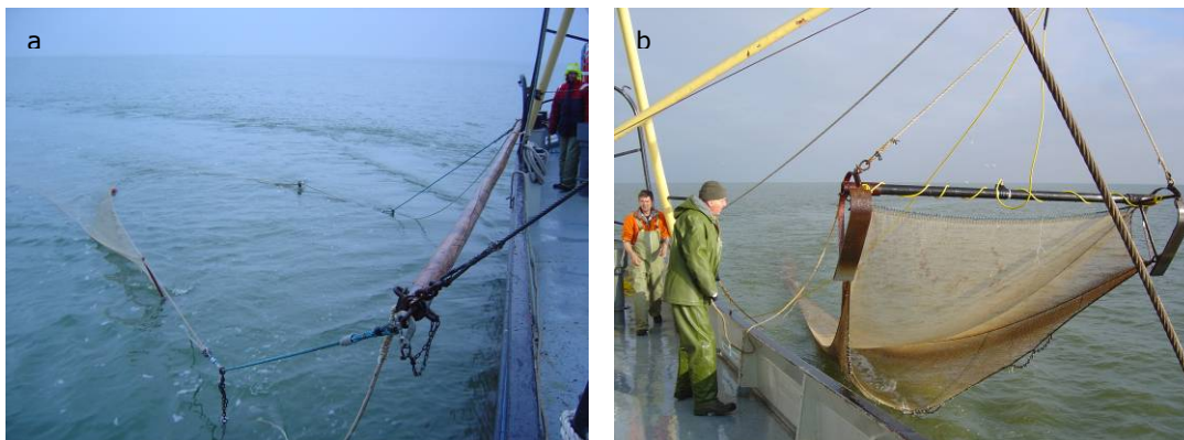
Figuur 2.1.2: Vistuigen in de open water bemonstering: grote kuil (a) en elektrostramienkor (b). Foto's: B. van Os-Koomen
