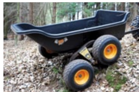
De Walking Arm volgt het terrein en houdt de bak in balans op ruw terrein.
