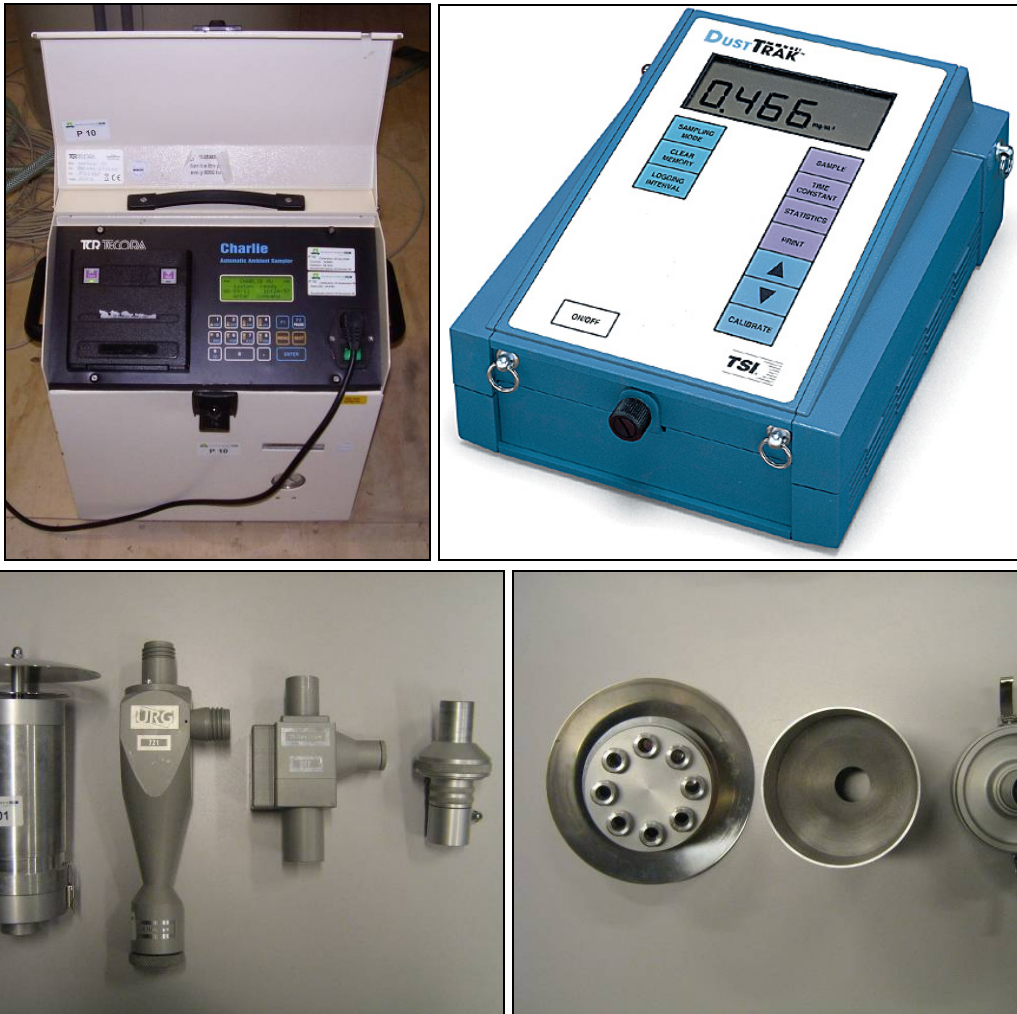
Figuur 1 Monsterapparatuur voor PM10 en PM2,5. Linksboven: de 'constant flow' monsternamepomp. Rechtsboven: de DustTrak model 8520 voor optische en continue metingen van het verloop in PM10 concentratie. Linksonder (van links naar rechts): inlaat, PM10 cycloon, PM2,5 cycloon en filterhouder. Rechtsonder (van links naar rechts): de constructie van de inlaat
