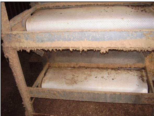
Geperforeerde polypropyleen mestbanden
