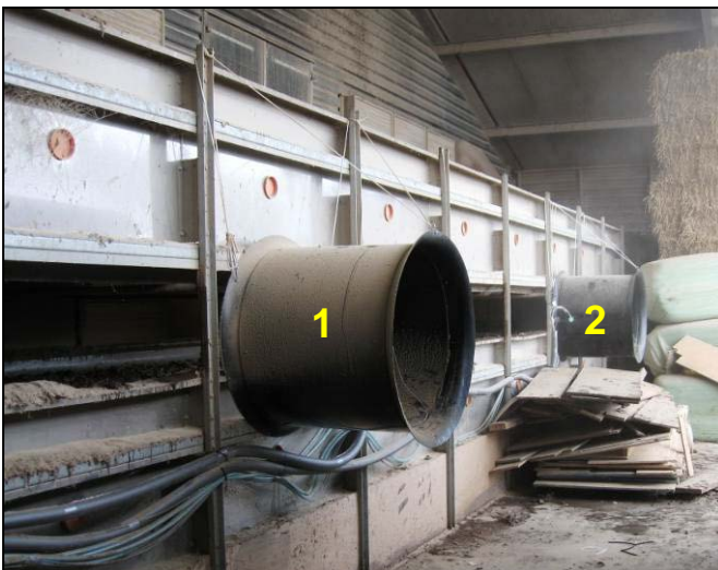
Twee meetopstellingen voor de uitgaande lucht
