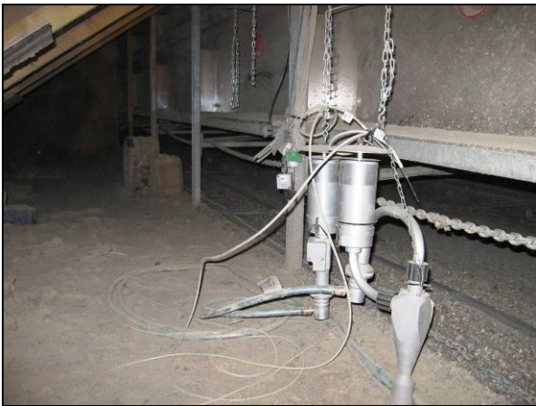
Meetpositie ingaande lucht van de droogtunnel (laag, platen 3 en 4) in de drukkamer
