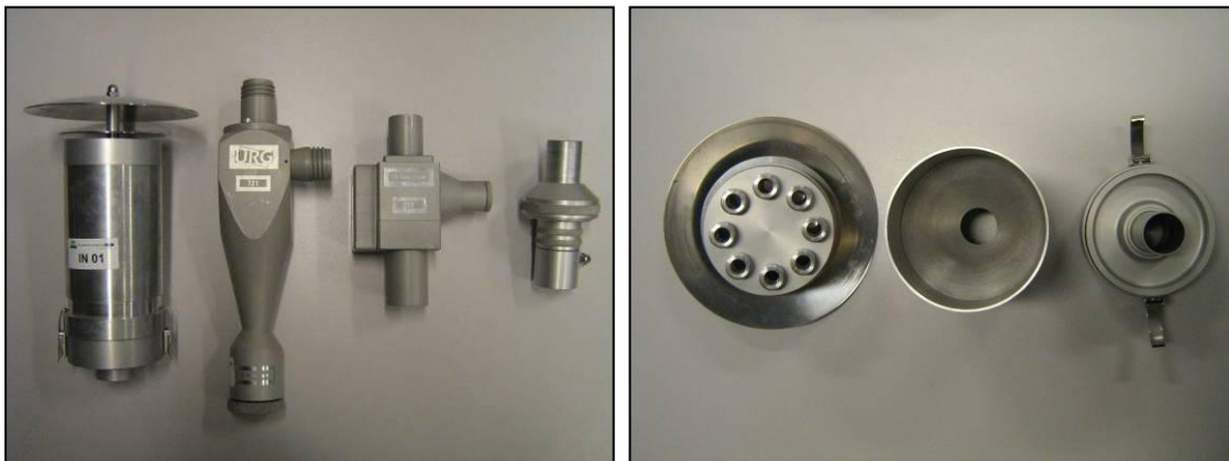
Figuur 1 Monsterapparatuur voor PM10 en PM2,5. Boven: de 'constant flow' monsternamepomp. Linksonder (van links naar rechts): inlaat, PM10 cycloon, PM2,5 cycloon en filterhouder. Rechtsonder (van links naar rechts): de componenten van de inlaat.
