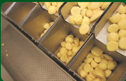
4. Na het schillen, eventueel in vorm snijden en uitsorteren van het product, weegt een machine in bakjes de precieze hoeveelheid per verpakking af.
