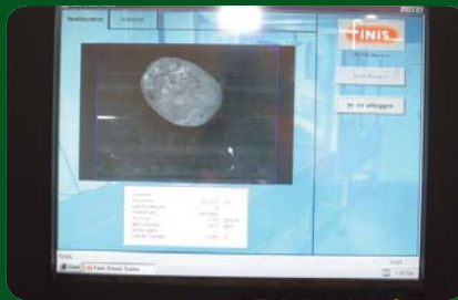
2. Op de transporteur naar de schilmachine komt elke aardappel op de foto om bij het schillen in de juiste stans te komen.
