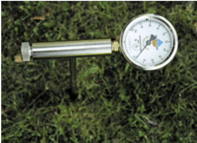
Een tensiometer die de beschikbare hoeveelheid bodemvocht voor de plant meet, helpt bij de beslissing 'wel of niet water geven'.
