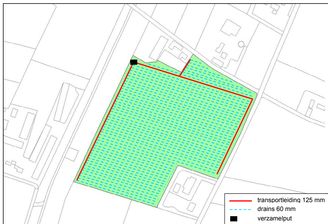
Figuur 5: Peilgestuurd drainage systeem voor bedrijf A
