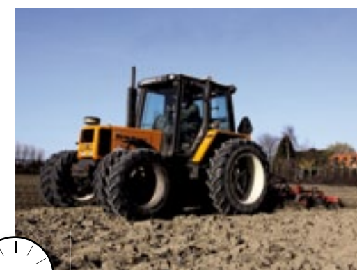
In Kwadendamme maakt P.J. Acda een perceel zware kleigrond klaar voor suikerbieten. Dankzij de goede structuur volstaat één bewerking met een Kongskilde triltandcultivator.
