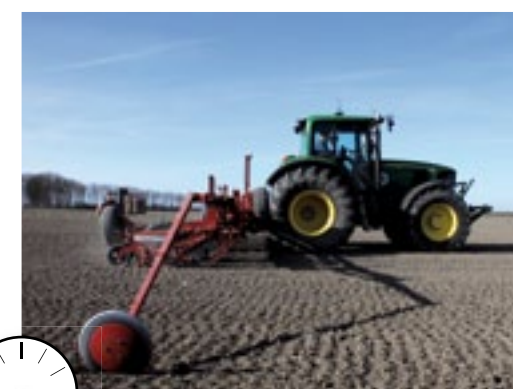
De Wilhelminapolder zaait de eerste suikerbieten met een 18-rijige Accord. De John Deere 6920 staat op brede lagedrukbanden. Ondanks gps gebruiken ze nog wel een markeur.
