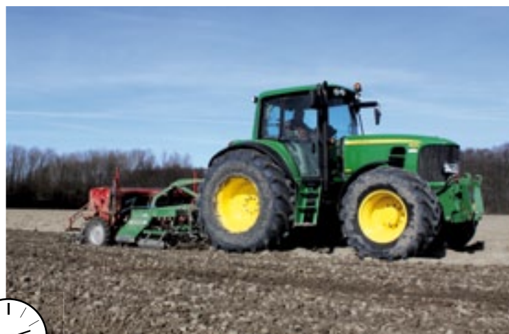
Bij Colijnsplaat zaait Sjaak van den Berg een perceel met zomertarwe met een Franquet zaaibedcombinatie in plaats van een kopeg. Hierdoor wordt de mulle structuur beter behouden en slaat die minder snel dicht na veel regen. Ook bespaart het brandstof en vergt het minder pk's.
