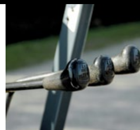
▲ Traditionele bediening, met van links naar rechts: heffen/dalen, neigen en de sidershift.
