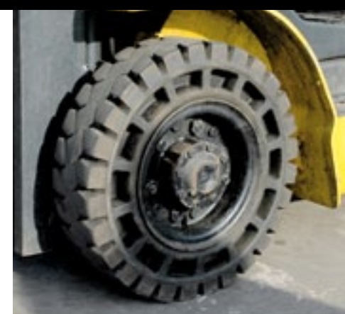
▲ Massieve banden met een dempend 'karakter' van het merk Rhino in de maat 7.00-12 5.00
