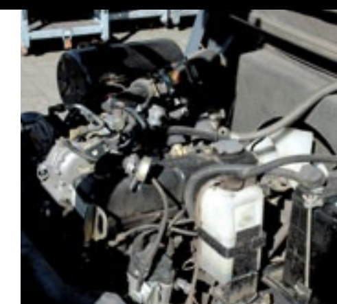
▲ De viercilinder 2,5-liter benzinemotor is afkomstig van Nissan en levert maximaal 43 kW/58 pk.
