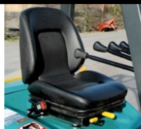
▲ Stoel met geveerd zitvlak en verstelbare leuning. De vierde hendel is de kantelaar.
