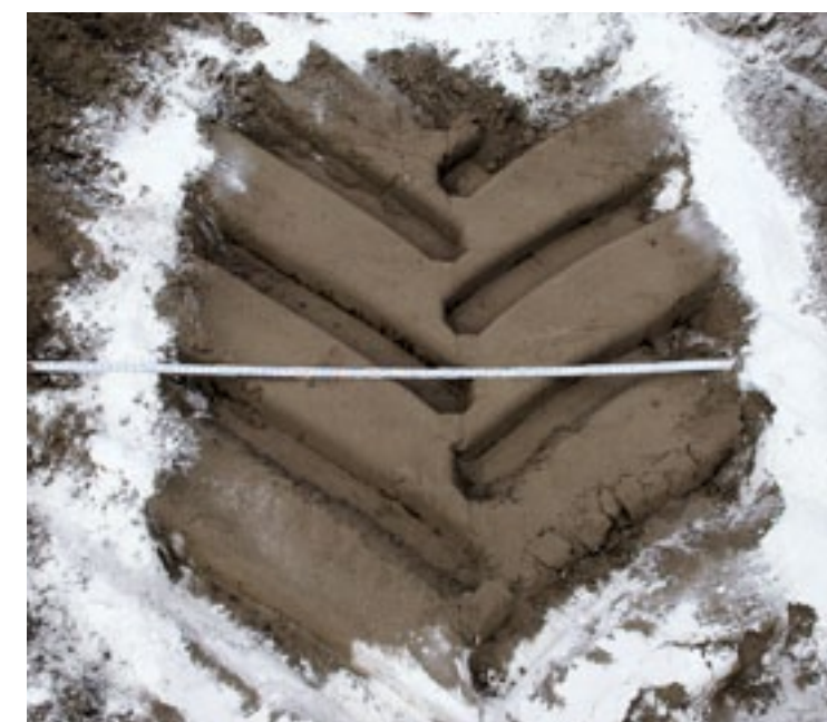
▲ De footprint van de Michelin CerexBib kenmerkt zich door een opvallend grote lengte ten opzichte van de breedte. De CerexBib heeft daardoor veel rubber aan de grond, terwijl de breedte beperkt blijft. De Franse bandenfabrikant en LandbouwMechanisatie zien dit principe als grote kanshebber voor de band van de toekomst.
