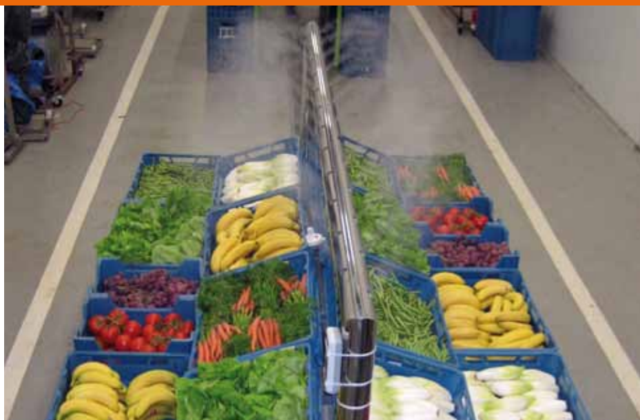
Proefopstelling voor onderzoek naar de conserverende werking van nevel.
