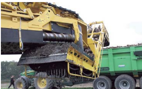
De Ropa euro-Maus 4 kan de bieten tot 15 meter zijwaarts afvoeren.
