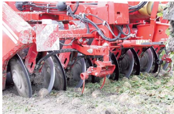
Aangedreven rooiwielen op de getrokken Grimme Rootster 604.
