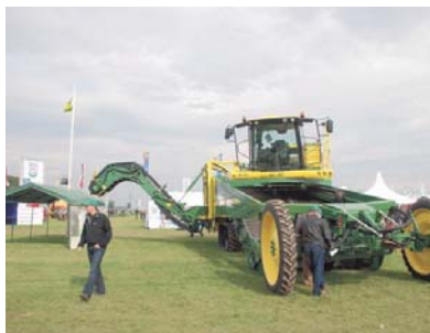
Ploeger demonstreerde haar AR-4B bunkerrooier, maar de meest opvallende vernieuwing stond langs de kant. Dit is de zelfrijdende AR-4W met een vernieuwde Claas-cabine; deze heeft meer glasoppervlakte dan zijn voorganger en kan gedeeltelijk draaien. Hierdoor heeft de chauffeur beter zicht op de elevator.
