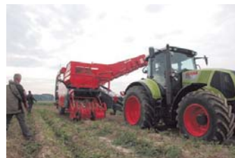
De RS2060 van Dewulf is nieuw. Hij rooit twee rijen aardappelen in verstek. De bunkerinhoud is circa 11m 3 . De wielen zijn extra breed. Onder de rooier is een band van één meter breed gemonteerd, het andere wiel is ruim 80 centimeter breed. De techniek komt overeen met die van de zelfrijdende machines van het merk. Opvallend detail is het grote doorkijkrooster aan de voorkant van de bunker. Deze geeft een goed beeld op de aardappelen.
