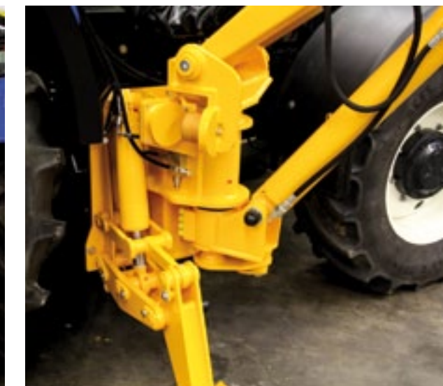
De nieuwe Grenadier maaiaarm heeft onder andere zwaardere lagers van de draaikop en het draaipunt heeft nu smeernippels.
