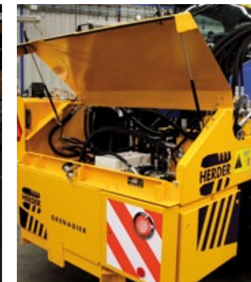
Op de achterzijde van de behuizing van het hydraulische systeem zitten twee uitschuifbare panelen met markering en verlichting.
