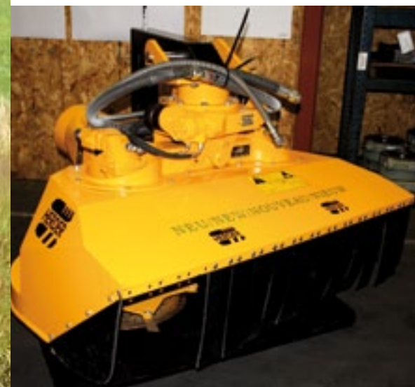
De nieuwe Herder Eco-maaier heeft twee trommels met onderaan schijven met mesjes. Er is geen zuigende werking.
