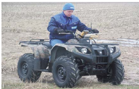
▲ Door met een quad met 3D gps-ontvanger over het land te rijden, worden de hoogtes van het perceel in kaart gebracht.
