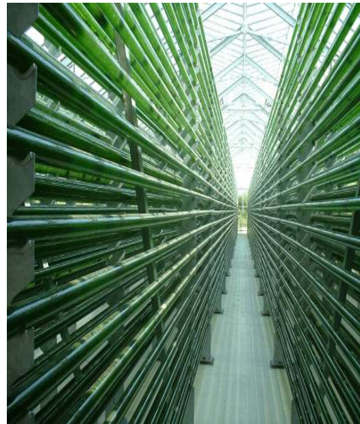
Figuur 2 Verschillende fotosynthetische systemen voor algenteelt. A: Open kweekvijver ('raceway pond') voor algenteelt op zonlicht; B: Gesloten fotobioreactor voor algenteelt op kunstlicht; C: 'Flat panel' fotobioreactor op kunstlicht; D: reactorbuizen in een kas. Bron foto's C en D: www.algae.wur.nl .
