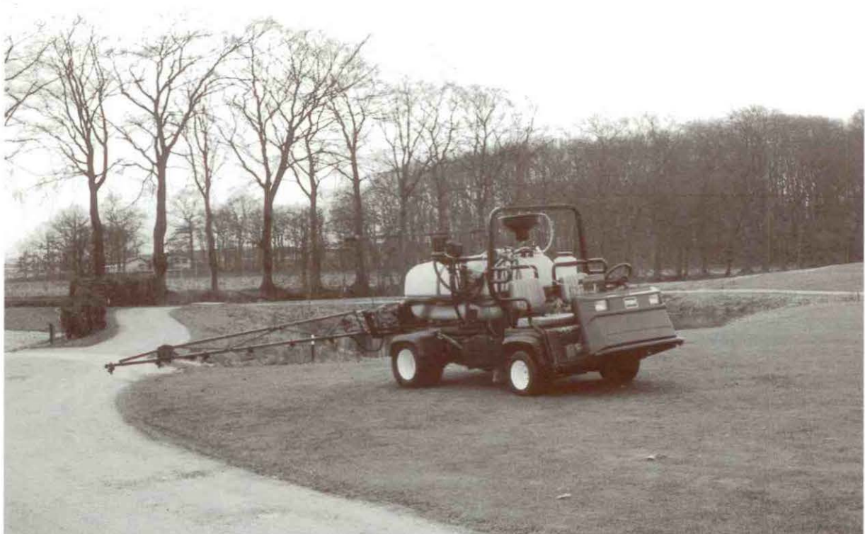
De Toro Workman is uitgerust met een 21 pk vloeistof gekoelde tegengebalanceerde dieselmotor.
