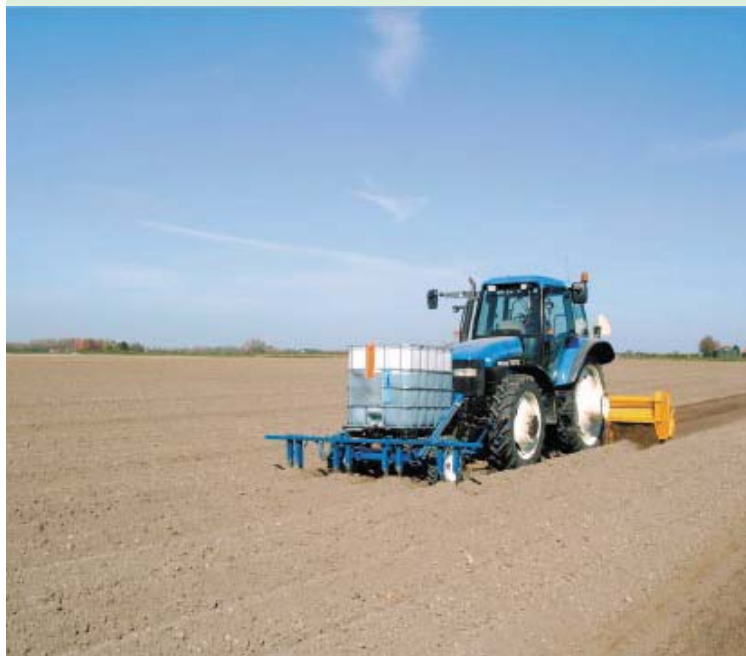
Dosering van fosfaat in de rij tijdens het anaarden. De kouters brengen de kunstmest vijf centimeter naast de aardappel.
