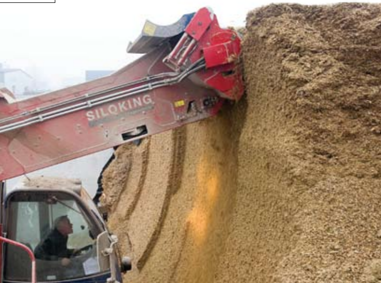
Een zelfrijdende voermengwagen mengt het rantsoen op het voercentrum
