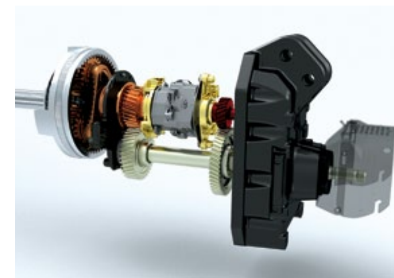
▲ De cvt aftakas van Case IH-moeder CNH bestaat uit een mechanisch en een hydraulisch deel. In de hydraulische unit zitten een pomp en een motor.
