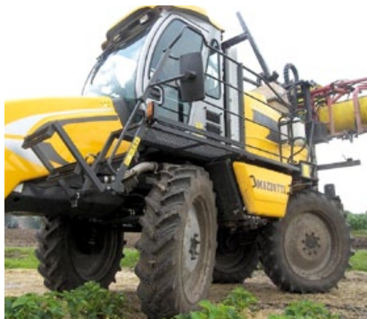
▲ Door de vierwielbesturing kun je erg kort draaien. Kleine kopakkers zijn dus mogelijk.
