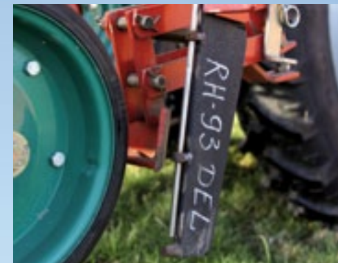
De vloeistof wordt met een kouter 3 cm onder en 7 cm naast het bietenzaadje gespoten.
