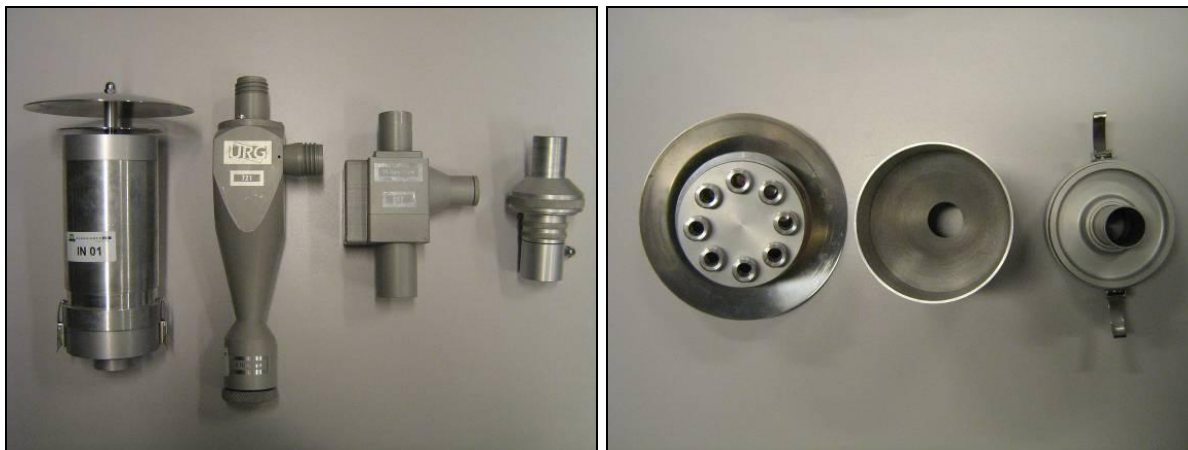
Figuur 1 Monsterapparatuur voor PM10 en PM2,5. Boven: de 'constant flow' monsternamepomp. Linksonder (van links naar rechts): inlaat, PM10 cycloon, PM2,5 cycloon en filterhouder. Rechtsonder (van links naar rechts): de constructie van de inlaat
