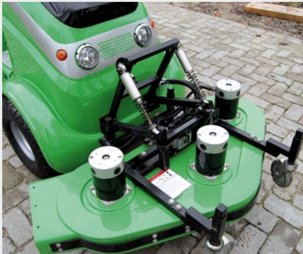
Het maaidek met drie elektromotoren hangt zwevend in de elektrische frontheff. De hef heeft een gepatenteerd snelwisselsysteem voor bijvoorbeeld een shovelpakje, rolbezem of schuif.
