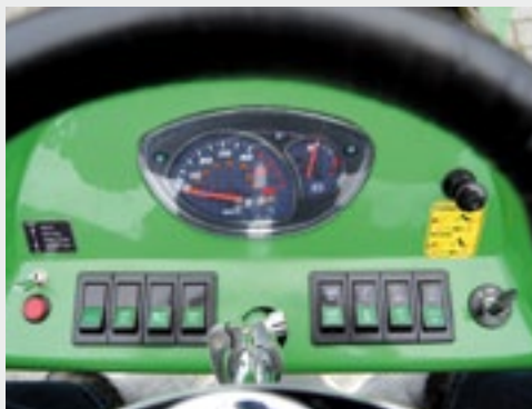
Links op het dashboard een rode knop met schakelaar voor de elektrische hef.
