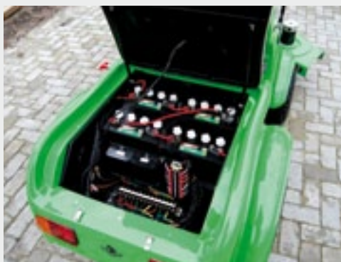
Achterin liggen vier van de zes accu's en de hele elektronische aansturing.
