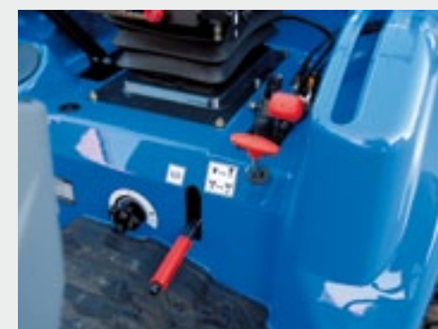
Boven de handrem zit een hendel voor de vierwielinschakeling. Daarboven zit de cruise control. Hiermee zet je het gaspedaal vast.
