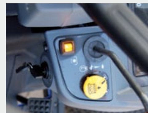
Met een knop, links onder de gele, kun je de aftakas langzaam in laten inschakelen bij zwaar aftakaswerk.
