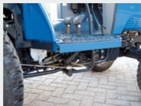
Er is een gaspedaal voor voor- en achteruit. Door deze in te trappen, neemt met de rijsnelheid ook het motortoerental toe.
