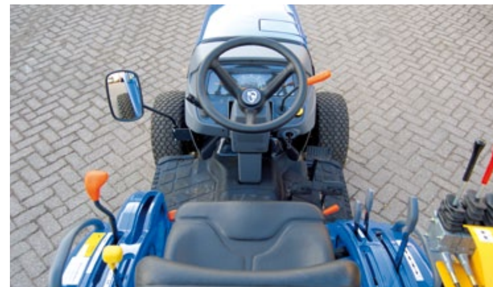
Het bestuurdersplatform van de Iseki TH 4365 is ruim, het bedienen gaat gemakkelijk. De hydrostaat heeft een top van 31 km/h en giert niet.
