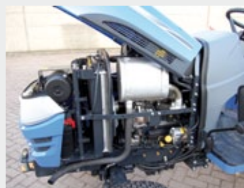
De TH 4365 heeft een nieuwe 26,8 kW (36,5 pk) Iseki driecilinder Stage 3B dieselmotor van 1.650 cc.
