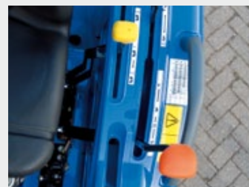
De grote oranje hendel is voor de hydrostaat met drie groepen, de twee gele zijn voor de aftakassen van ondermaaidek en 540/1.000.
