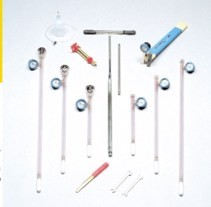
Een tensiometer meet de beschikbaarheid van water in een bepaalde grond. (foto met dank Eijkelpark Agri-search Equipment)
