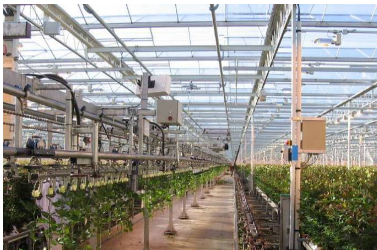
Figuur 2.3 Teelt op teeltgoten en centrale transportband
