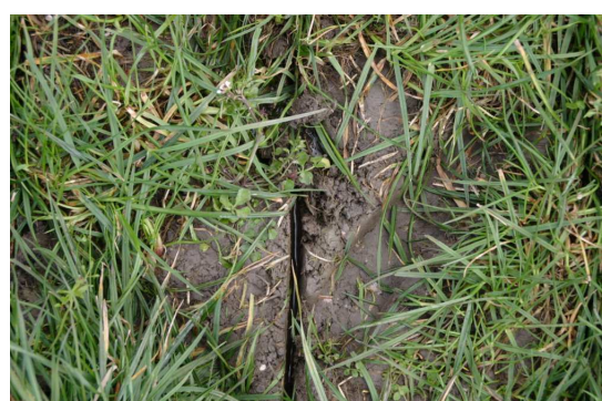
Figuur 12. Toedieningstechniek mineralenconcentraten in de veldproeven met grasland (onder) en aardappelen (boven).
