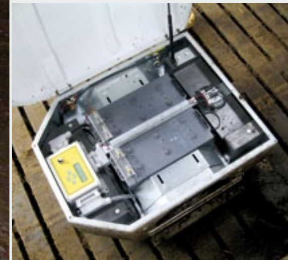
Links de computer van de Roboclean, in het midden de twee accu's en voor en achter een fors gewichtblok.
