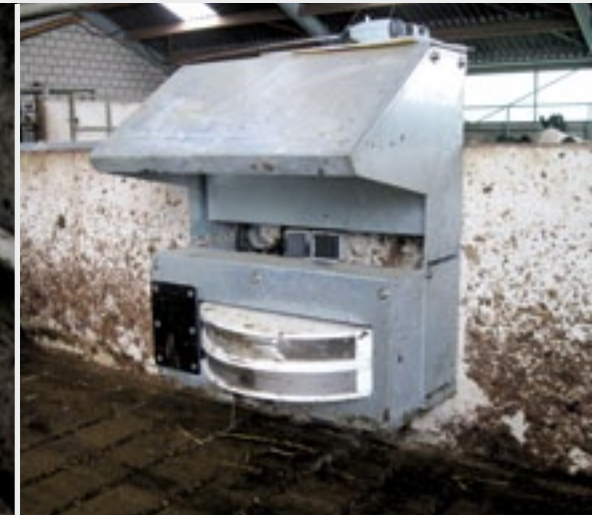
De metalen strips op het witte vlak van het laadstation maken contact met de contactstrips op de robot.
