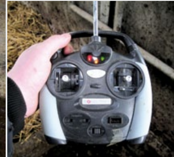
Met deze radiografische afstandsbediening bedien je de Roboclean. De robot kan op dat moment niet op de automaatstand rijden.
