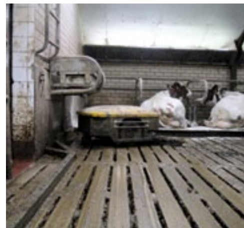
De Roboclean in actie. Let op de balk die voor de melkstal geplaatst is.
