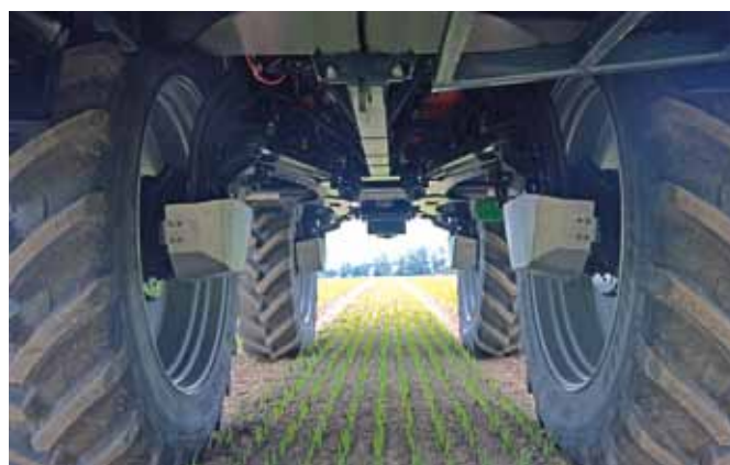
◀ Het onderstel met de bekende pendelende draagarmen kent in vering en tractie veel elektronisch vernuft. Moet je zelf ervaren. De machine kan niet op 1,50 meter spoor.
