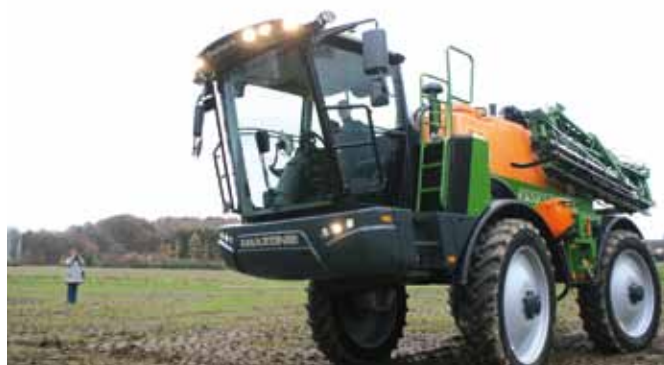
◀ De cabine is onmiskenbaar afkomstig van Claas. Voor in de neus zit nog een handige opbergruimte. Prettig voor Nederland zijn de compact opklappende spuitbomen.
