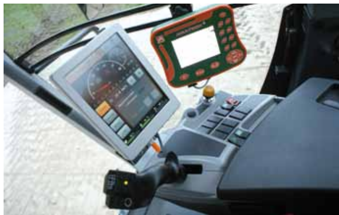
◀ In de cabine valt het dubbele scherm op: het bekende Amazone-scherm voor het spuitgedeelte en de nieuwe terminal met touchscreenbediening voor het rijgedeelte.
