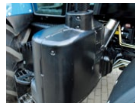
▲ Het SCR-filter rechtsvoor. De 48 liter AdBlue tank zit naast de 330 liter brandstoftank.
