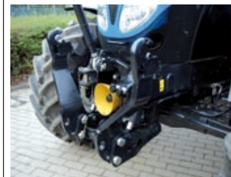
▲ De af-fabriek frontheff tilt tussen de kogels 3.586 kg. Er is ook een Zuidberg-versie.
