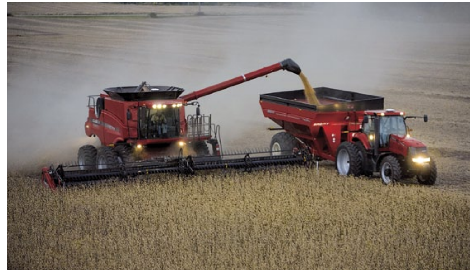
▲ Case IH presenteert V2V (vehicle-to-vehicle). Dit is een onderdeel van het Advanced Farming System (AFS). De chauffeur van de maaidorser beïnvloedt het stuur- en snelheidssysteem van de naast rijdende trekker, waardoor die zonder chauffeur de maaidorser kan volgen. V2V is vooral bedoeld om het lossen van de maaidorser efficiënter te laten verlopen. Het zou toe te passen zijn bij alle combinaties van twee naast elkaar rijdende voertuigen, dus ook bij aardappel- en bietenrooiers.
